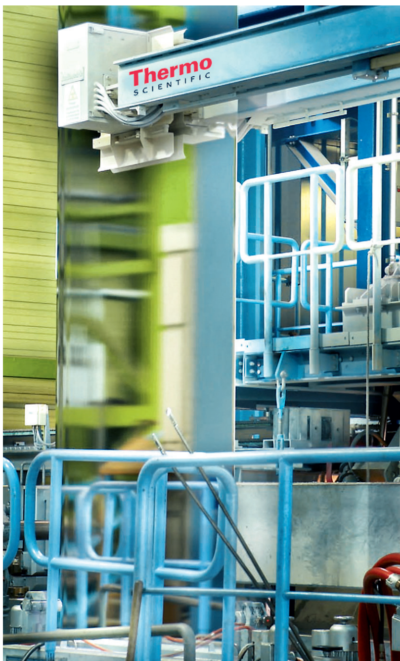
▲ Thermo Scientific SIPRO Messsystem für Warmbandstraßen. Der obere Bügelarm im Foto enthält die beiden Röntgenquellen, im anderen Bügelarm unterhalb des Warmbandes befinden sich die Detektorarrays. Das Messsystem liefert Warmband-Dickenquerprofile im 5 Millisekundentakt.
