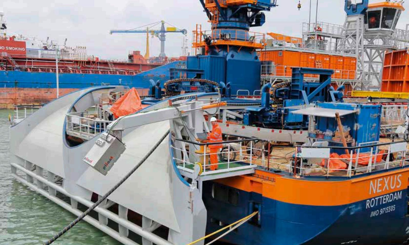
▲ Der DAM ist direkt beim CHUTE montiert. Der vorhandene Arm ermöglicht ein leichteres Einlagern.
