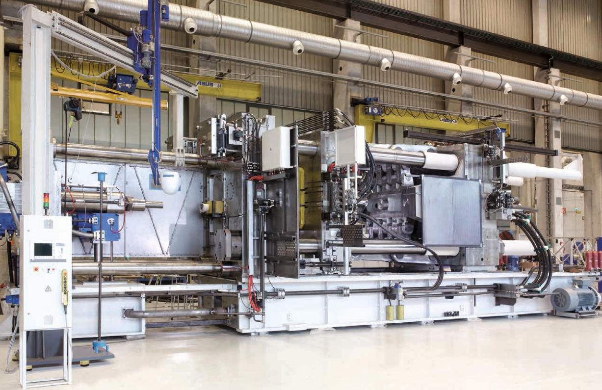
◀ Kaltkammerdruckgießmaschine der Reihe GDK von Frech: Bis zu 5.000 Tonnen (50.000 kN) Schließkraft (Aufbau im Montagewerk vor der Lackierung.)
