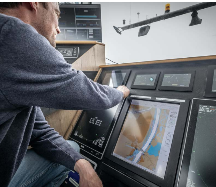
Eine Person befindet sich zur Überwachung an Bord, gesteuert werden die River Drones jedoch vollständig von Land aus.
