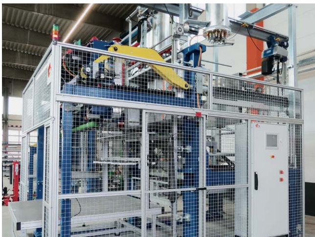
Eröffnet neue Märkte: FoamaTec nutzt den neu unterstützten Antriebstop von Schneider Electric zum synchronen Verfahren einer Schließeinheit für große Partikelschäummaschinen.
