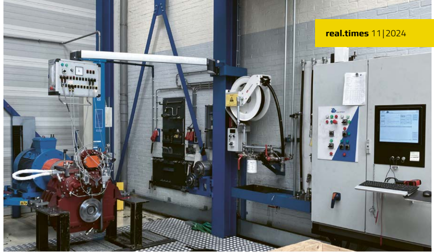
Ein von Verhoef Elektrotechnik umgesetzter Getriebeprüfstand: Erfolgte die Dokumentation der Prüfung bislang durch das Bedienpersonal von Hand, erhält der Kunde dank WebMI pro und Scope 3 nun automatisch einen detaillierten PDF-Bericht der kompletten Prüfung inklusive Trend der Ein- und Auskupplung. © ADS van STIGT
