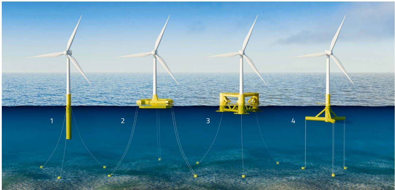
In den aktuellen Pilotprojekten zu Floating Wind werden derzeit vor allem vier Systemansätze verfolgt, um die besten Lösungen zu finden: (1) Spierenboje, (2) Kahnplattform (engl. barge platform), (3) Halbtaucher (engl. semi-submersible), (4) Spannbeinplattform (engl. Tension-Leg Plattform, TLP).
