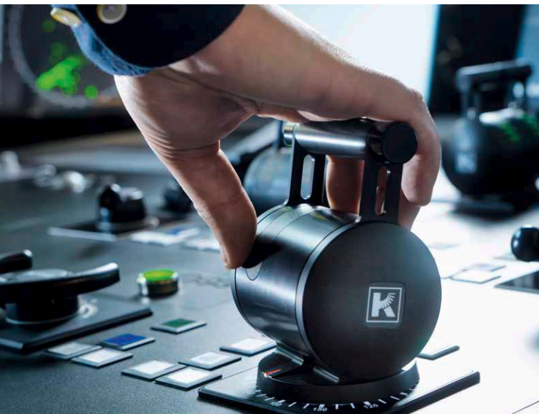
Die komplexen Algorithmen für das haptische Feedback der Steuerhebel entwickelt Kwant Controls mit einer Rapid-Prototyping-Plattform, die auf dem M200-Steuerungssystem basiert.
