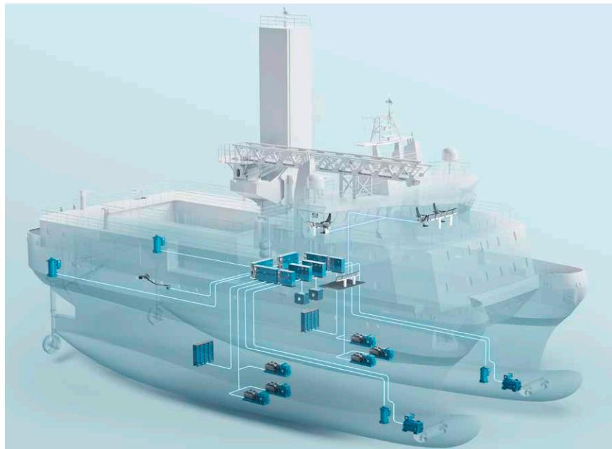
33 Bachmann-M200-Systeme bilden das Rückgrat von Überwachung und Steuerung des komplexen Energiemanagements auf dem Schiff. Bild: NES
