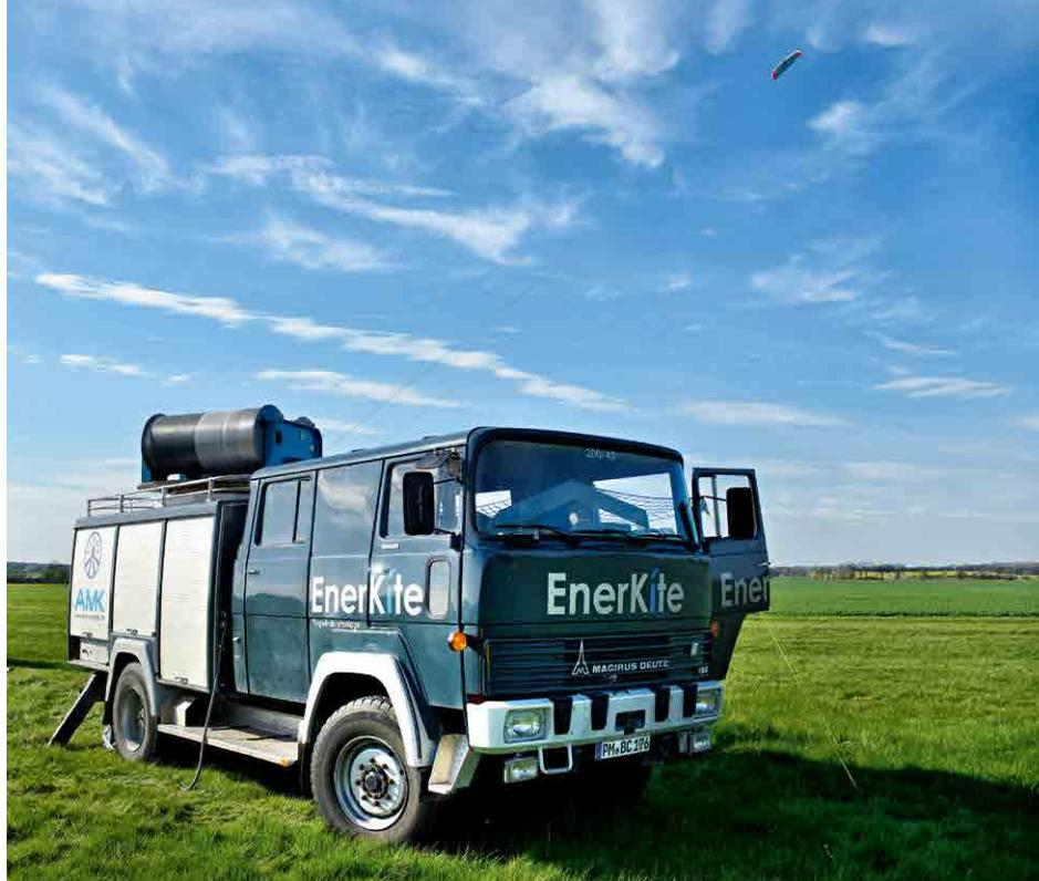
▲ Für den Testbetrieb verwendet EnerKite einen LKW als Bodeneinheit, in der der Strom mittels Generator in der Seilwinde erzeugt wird.
