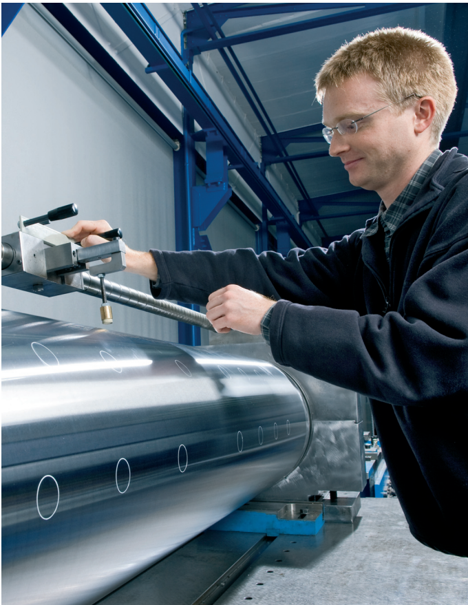
▲ Ausgeklügelte Anordnung der Sensoren: Achenbach Techniker Tim Schuhmacher kalibriert eine Planheitsmessrolle
