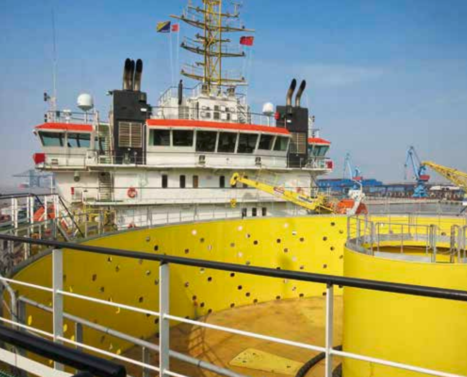
▲ Die riesige Kabeltrommel auf der Ndurance.
