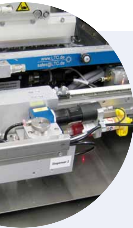
◀ Doppeldispenseinheit im ERSA-Schablonendrucker
