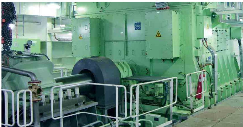
▲ Einer der beiden Propellermotoren im Kreuzfahrtschiff »Royal Princess«.
